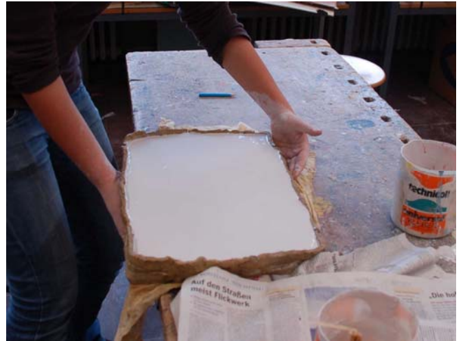
Rütteln der Gussform, um Luftpinschlüsse zu vermeiden
